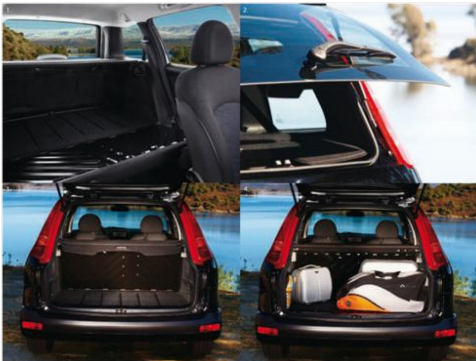
1. Asiento rebotable 1/3 y 2/3 según versión / 2. Luneta trasera con apertura individual / 3. y 4. Gran versatilidad de carga.
